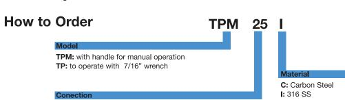
**25:** 1/4 NPT M **50:** 1/2 NPT M **75:** 3/4 NPT M **80:** 1 NPT M
