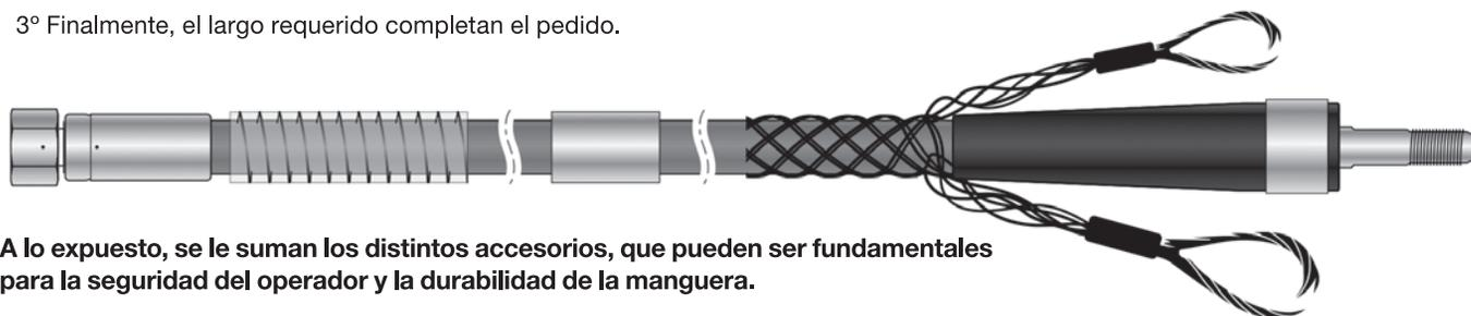
A lo expuesto, se le suman los distintos accesorios, que pueden ser fundamentales para la seguridad del operador y la durabilidad de la manguera.
